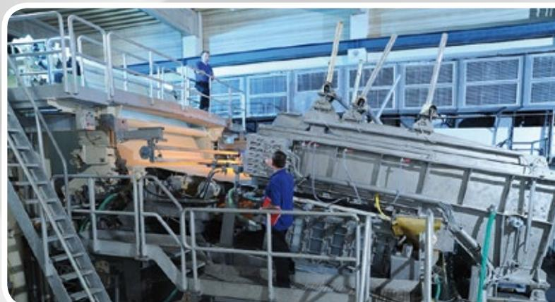
Modernste Schrägsiebtechnologie: Stoffauflauf der PM6
